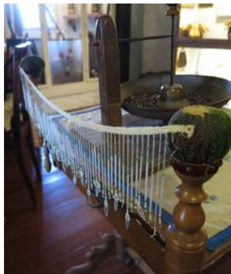
Moulin de préenfilage et potelets pour la confection d'une frange de perles. Musée de Geyer.
